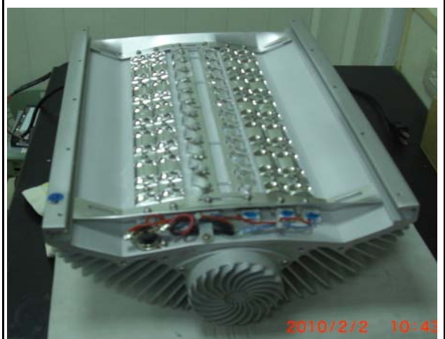
LED光源燈條安裝，T. I. M矽質散熱膏
